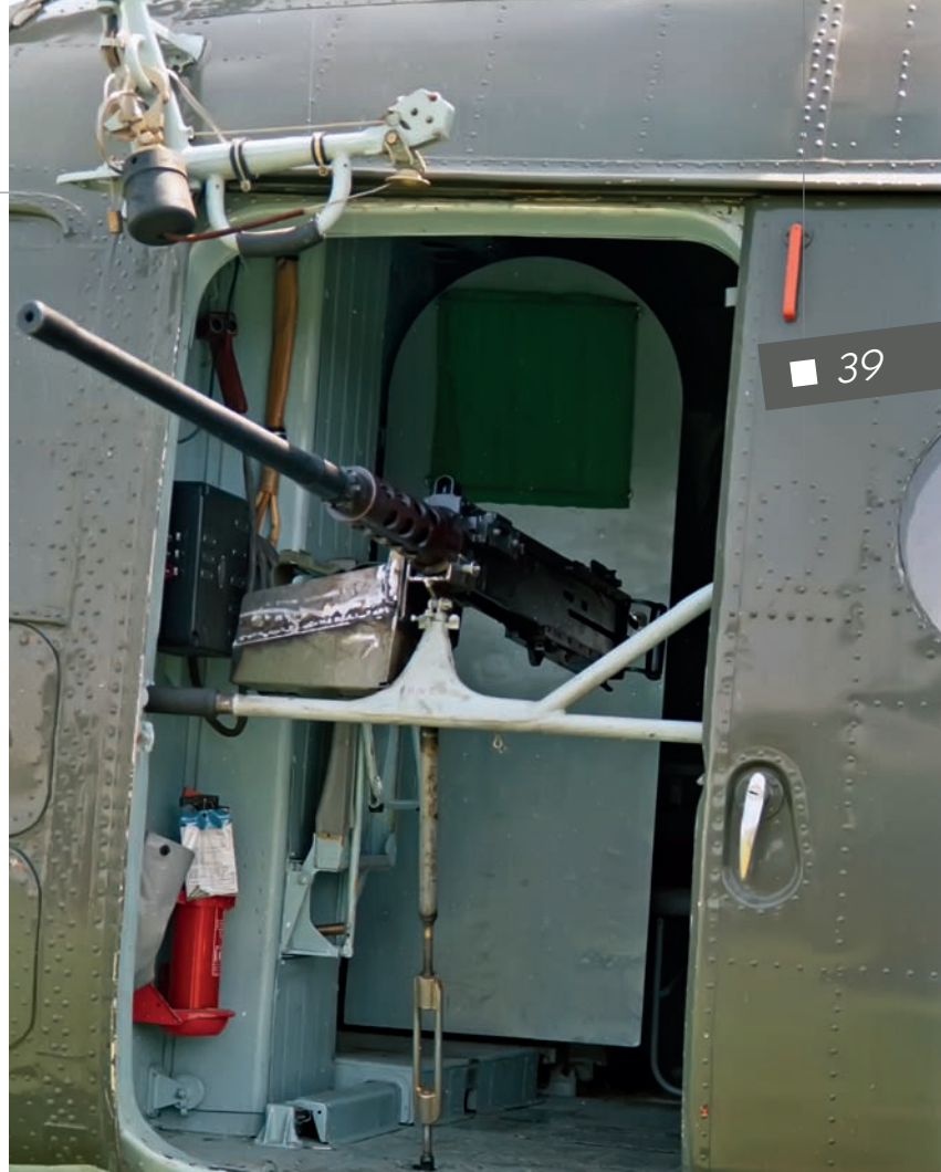
На вратима Ми-8 у позицији за дејство митраљез је постављен на носач и учвршћен додацим ослонцем за њог шерејне кабине (ВОЦ)
